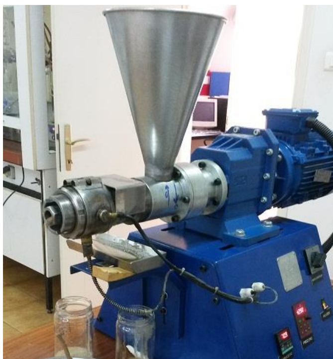
Slika 8 Pužna preša pomoću koje smo proizveli hladno prešano ulje iz koštica marelice
