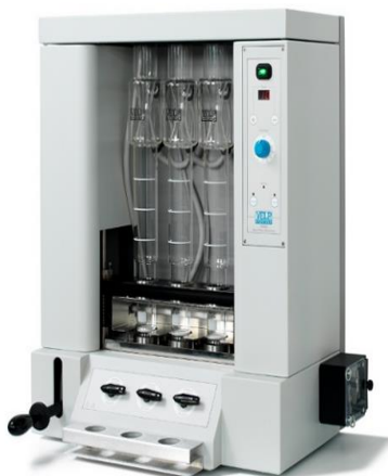
Slika 7. Uređaj za određivanje vlakana u uzorku (Velp, 2015).
