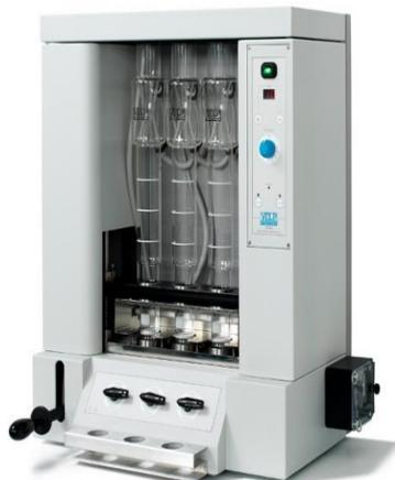
Slika 7. Uređaj za određivanje vlakana u uzorku (Velp, 2015).
