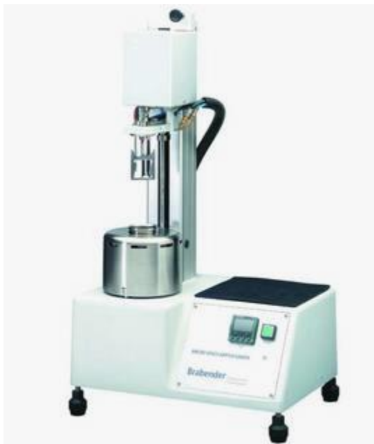
Slika 16 Mikro visko-amilograf (Brabender OGH, Disburg, Njemačka)
