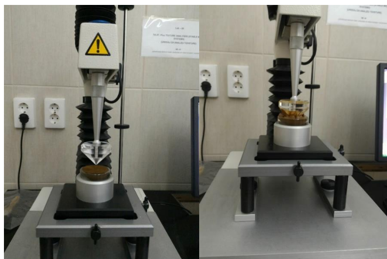
Slika 17 Prikaz prodiranja nastavka za teksturu konusnog oblika
