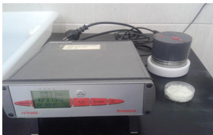
Slika 11 HygroLab 3 (uređaj za određivanje aktiviteta vode)
